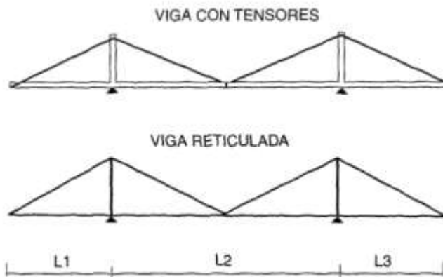
Control de la deformación de un voladizo con tensor
