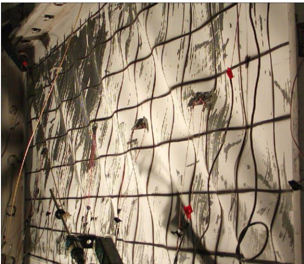
Fig. 8-12. Vista de la placa de acero, con clara evidencia de fluencia y pandeo, en ensayos realizados por Berman y Bruneau (2003) .
