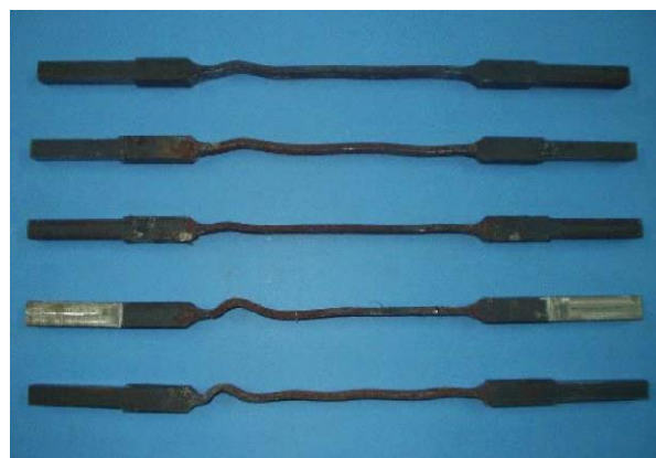
Fig. 7-8. Vista del núcleo de acero de riostras de pandeo restringido ensayadas por Palazzo et al. (2009).
