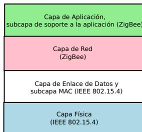
**Figura 2.5: Pila del Protocolo ZigBee.**
