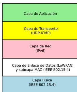
**Figura 2.7: Pila del protocolo 6lowPAN.**
