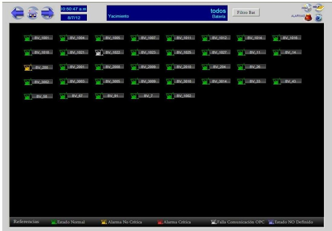
Figura 61: Pantalla de resumen de alarmas de pozos en el HMI de Iconics
